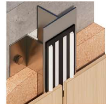
PEGADO SISTEMA DE FIJACIÓN OCULTO CON ADHESIVO ESTRUCTURAL A UNA SUBESTRUCTURA DE ALUMINIO
